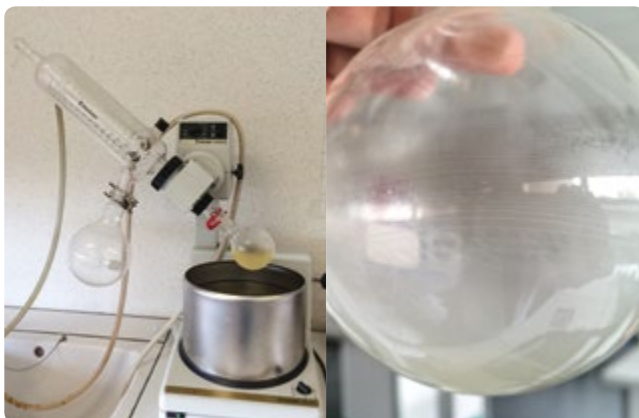
FIG. 8 Avdunstning av lösningsmedlet med en rotationsavdunstare (vänster) · Pulver på kolvens sidor efter att lösningsmedlet har avdunstat
