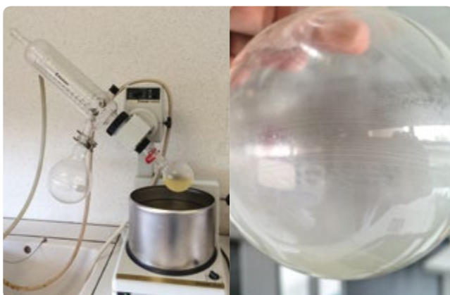
8. ÁBRA Az oldószer elpárolgatása forgó párologtatóval (balra) · A lombik falán lerakódott por az oldószer elpárolgása után
