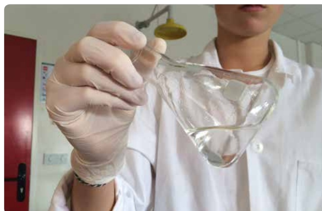
FIG. 4 Secado de la fase orgánica con un desecante
