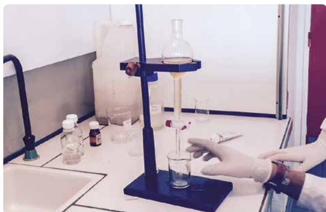
FIG. 3 Extracción del solvente de la cafeína
