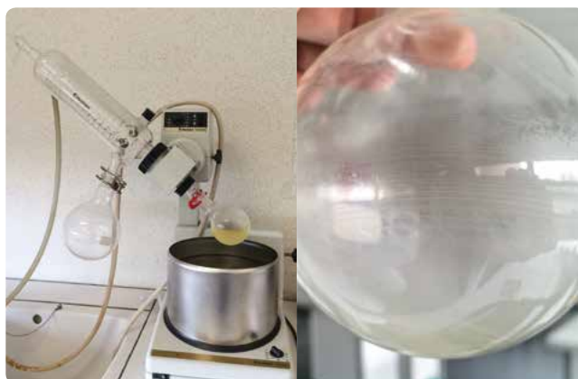
FIG. 8 Evaporación del solvente con un evaporador rotativo [izquierda] Polvo al lado del recipiente tras la evaporación del solvente
