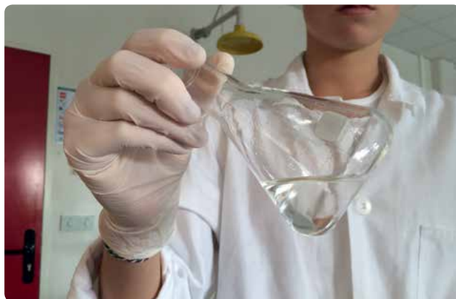
OBR. 4 Sušení organické fáze pomocí vysoušedla
