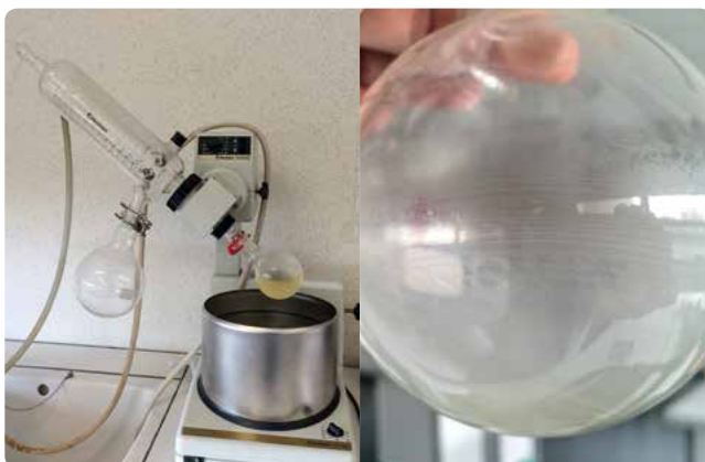
OBR. 8 Odpaření rozpouštědla pomocí rotačního odpařovače (nalevo) · Prášek na boční straně lahve po odpaření rozpouštědla
