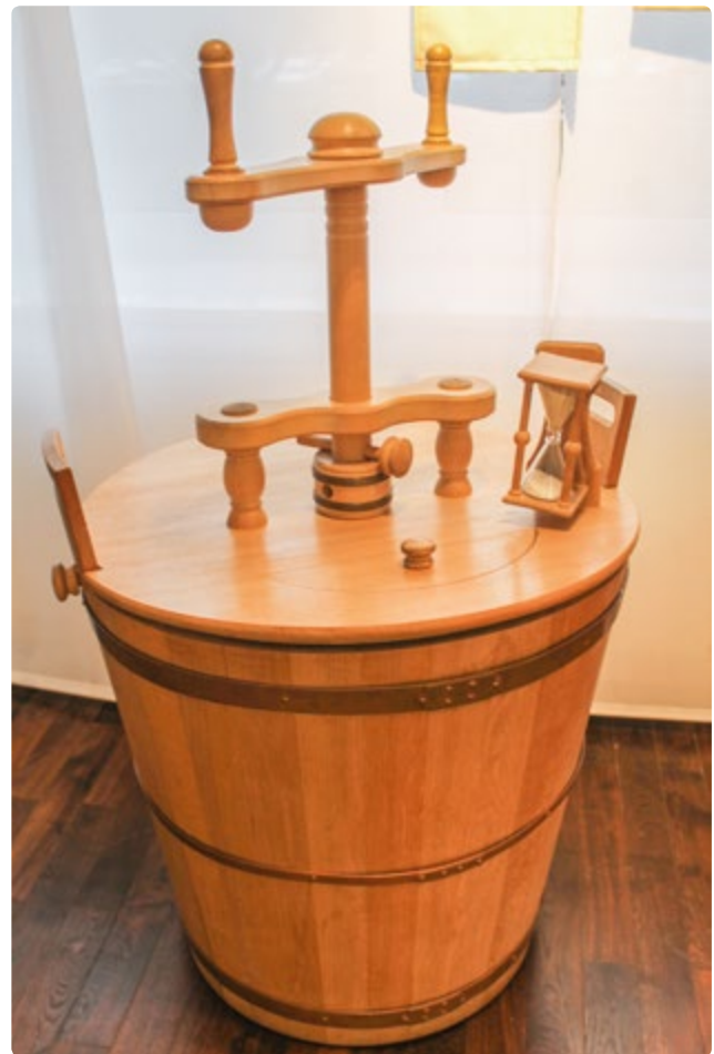
ABB. 1 Regensburger Waschmaschine von 1767 (originalgetreuer Nachbau)
